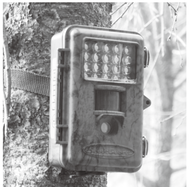
電柵内に獣が進入する状況を監視する夜間動画撮影カメラ。
