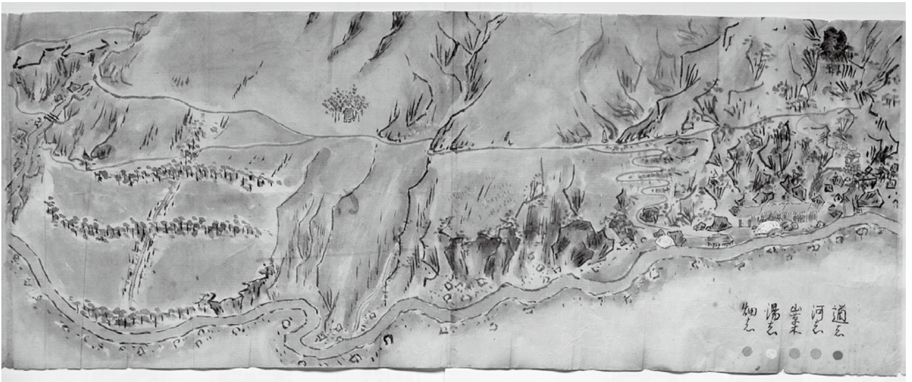
この絵図から220年ほど前、江戸時代後期ですが、わなばの湯・元湯から現在の山田温泉に引湯するために描かれたものです。真ん中に薄いですが、1本の線が引かれております。この線に沿って木棺をつないで湯をひいてきました。大変な工事だったようです。
