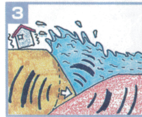
ひずみが限界に達し、陸のプレートの先端が跳ね上がり、地震が発生します。
